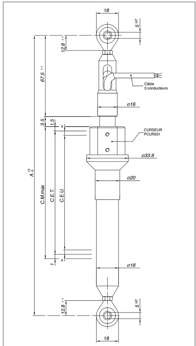
**Important:** toutes les données fournies dans le catalogue pour les valeurs de linéarité et les coefficients de température sont valables pour l'utilisation du capteur comme diviseur de tension avec un courant maximum circulant dans le circuit  $I_c < 0.1 \mu A$
