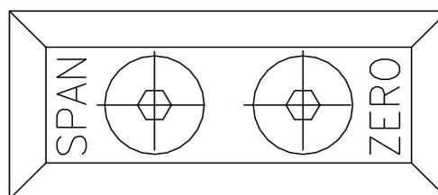
Le réglage du signal à la pression ambiante (ZERO) et le réglage à la pression nominale (SPAN) peuvent être effectués en agissant sur les sélecteurs spécialement prévus à cet effet, accessibles à l'intérieur du transmetteurs, après avoir ôté les deux vis de fixation.
