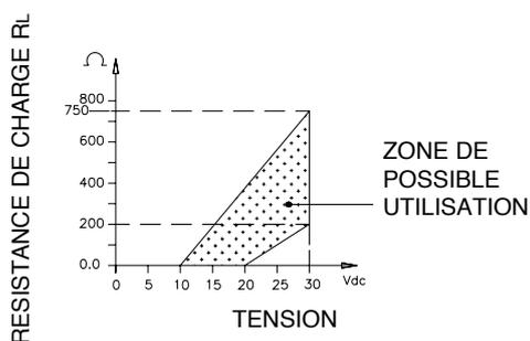
Le diagramme représente le rapport optimal entre la charge et l'alimentation pour les transmetteurs avec sortie 4...20mA. Pour un fonctionnement correct, utiliser une combinaison de résistance de charge et de tension d'alimentation telle à rester dans les limites de la zone ombrée.
