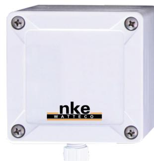
Le capteur PULSE SENS'O permet de télélever les données de comptage provenant de la sortie impulsionnelle des compteurs d'eau, de gaz, d'électricité ou thermique. Il transforme les compteurs existants en compteurs communicants via un réseau public ou privé LoRaWAN™.
