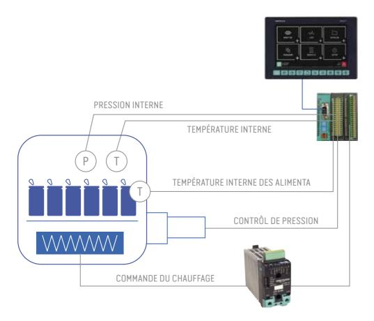
Les principales caractéristiques de ces applications concernent le stockage des valeurs de processus pendant le cycle de stérilisation ainsi que le calcul FO, à savoir le temps équivalent à la température de stérilisation. Le calcul du facteur FO permet de vérifier, garantir et certifier automatiquement les paramètres de qualité du produit traité.
